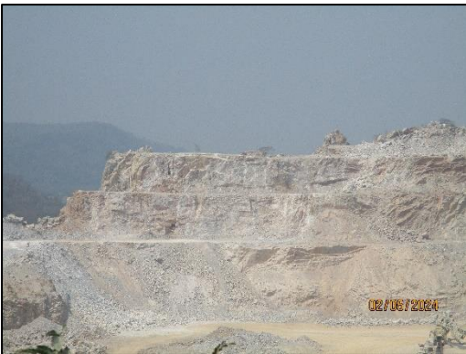
รูปที่ 2-11 การทำเหมืองแบบขั้นบันได
